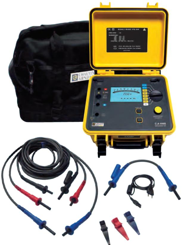
El megaóhmímetro C.A 6505 se entrega de serie con una bolsa de transporte, cables de 2 m terminados en pinzas de cocodrilo perfectamente aisladas y de gran tamaño, 2 cables de medición y un cable de protección para las mediciones de alto aislamiento.
