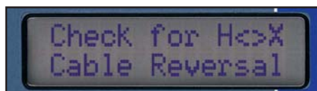
Detecta y muestra automáticamente conexiones inapropiadas de cables
