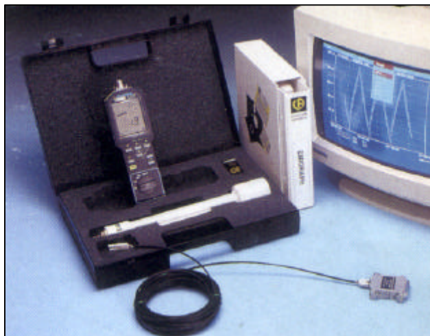
CA 43 con sus accesorios (maletín sonda EF2, software, cable fibra óptica y adaptador optoelectrico)
