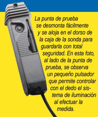
La punta de prueba se desmonta fácilmente y se aloja en el dorso de la caja de la sonda para guardarla con total seguridad. En esta foto, al lado de la punta de prueba, se observa un pequeño pulsador que permite controlar con el dedo el sistema de iluminación al efectuar la medida.
