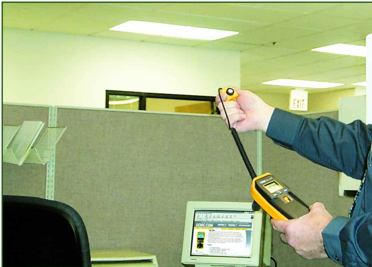
Con el sensor extraíble la medida de iluminaciones evitando sombras es sencilla.
