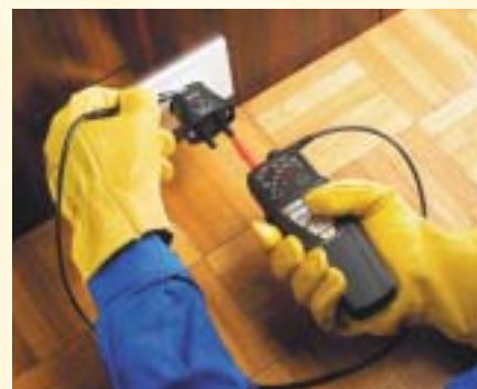
El sentido de rotación de las fases está definido en régimen de neutro TT, TN o IT, gracias a un innovador método de 2 hilos. Este control funciona sobre grupos electrógenos.
