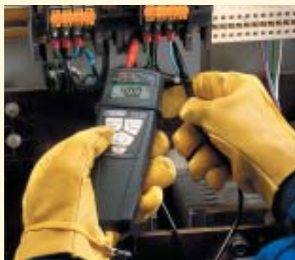
El sentido de rotación de las fases está definido en régimen de neutro TT, TN o IT, gracias a un innovador método de 2 hilos. Este control funciona sobre grupos electrógenos.
