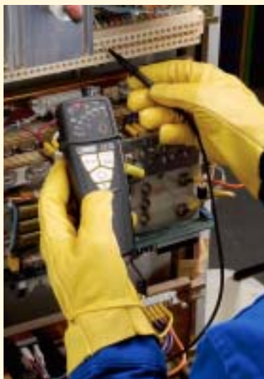
Con cada uno de los verificadores, sólo se necesita una sola mano para detectar fácilmente la fase. Para el C.A 704, la tensión se mide paralelamente.
