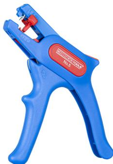
WEICON TOOLS Tenaza Pelacable No. 5 La herramienta pella todos los conductores de hilo y cable de uso habitual de 0,2 a 6,0 mm<sup>2</sup> (24 – 10 AWG). Dispone de un tope ajustable de longitud entre 5 y 12 mm. El tope de longitud es extraíble si fuera necesario. Una cuchilla lateral fácilmente accesible que trabaja en diámetros de cable hasta 2 mm, está integrada en la herramienta. Las cuchillas son intercambiables. El bajo peso de la No. 5 garantiza un trabajo sin fatiga.
