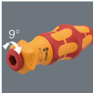
La carraca integrada con dentado fino (40 dientes y un ángulo de retorno de 9°) facilita y acelera el trabajo de atornillar sin la molestia de tener que reposicionar el útil.
