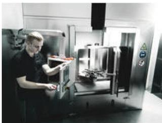
La prueba individual pieza por pieza a 10.000 voltios según la norma IEC 60900 garantiza un trabajo seguro bajo tensiones de hasta 1.000 voltios.
