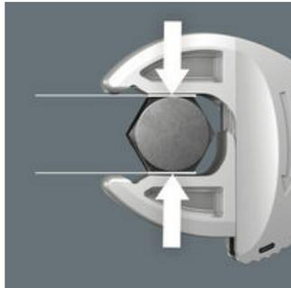
Las mordazas lisas y paralelas de la llave Joker 6004 permiten una presión sobre las superficies, y de esta forma pueden evitar un redondeo de la tuerca o de la cabeza del tornillo, un fenómeno que puede suceder en la transmisión de fuerzas a lo largo de ángulos.
