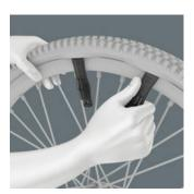
ayuda Con de las llaves desmontaneumáticos de material plástico con refuerzo de fibra de vidrio, es posible levantar los neumáticos de manera segura de la llanta haciendo palanca, sin causar daños en la llanta. Con una de las llaves desmontaneumáticos levantar el neumático de la llanta, engancharla en un radio, y luego, desprender el neumático de la llanta con ayuda de la segunda llave. Es posible enganchar los dos desmontaneumáticos el uno con el otro, y asi no se pierde ninguno de los dos.
