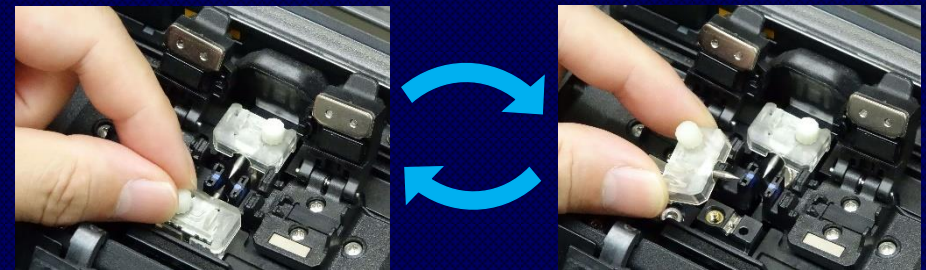
Sustitución de electrodos sin herramientas
