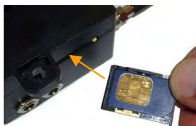
Una vez efectuadas las operaciones anteriores, observará que los pilotos de "modo" y "GSM" parpadearán durante unos segundos, transcurrido este tiempo el piloto de "Modo" se pondrá en color rojo y el piloto "GSM" se quedará parpadeando en color verde.
