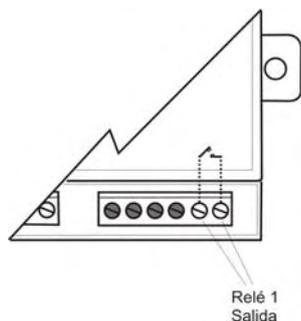
El CCGSM11 dispone de dos relés de salida que permiten gobernar cualquier aparato eléctrico o electrónico cuyas características no superen un consumo de 3A a una tensión de 220 VAC
