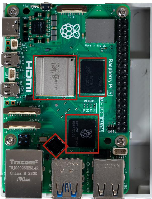
Si desea utilizar el refrigerador activo, ahora puede presionar el panel acrílico fuera de la carcasa e insertar el panel con el refrigerador integrado. Ahora conecta el cable del ventilador al conector del ventilador de tu Raspberry Pi 5:
