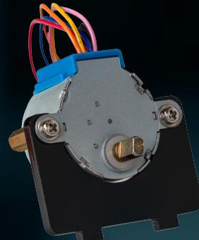
En primer lugar, coloca el primer marco acrílico negro en tu motor paso a paso e inserta los dos tornillos con las dos arandelas a través de los orificios.
