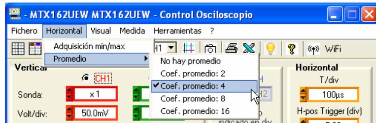
Cuando un promedio está activado, su coeficiente aparece en la ventana « Traza osciloscopio » :
