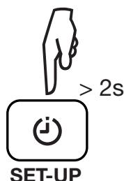
Pulsar de forma prolongada la tecla **SET-UP** permite entrar en la configuración (set-up) del instrumento.
