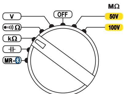
Como para una medida de continuidad, conecte el dispositivo a probar a los bornes del instrumento. El dispositivo a probar no debe estar encendido (véase § 2.4.3).
