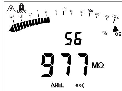
**i** En medida de aislamiento, sólo se modifica la visualización digital mediante la función **ΔREL**. La barra analógica sigue mostrando el valor real de la medida.
