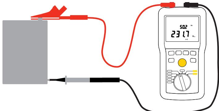
El instrumento indica la tensión presente en los bornes. Detecta si la tensión es alterna o continua. Para el C.A 6532, en caso de una tensión alterna, el instrumento indica también la frecuencia.
