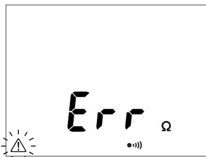
Durante la medida de continuidad, de resistencia o de capacidad, si el instrumento detecta una tensión externa superior a 15 V (alterna o continua), interrumpe la medida y muestra la siguiente pantalla.
