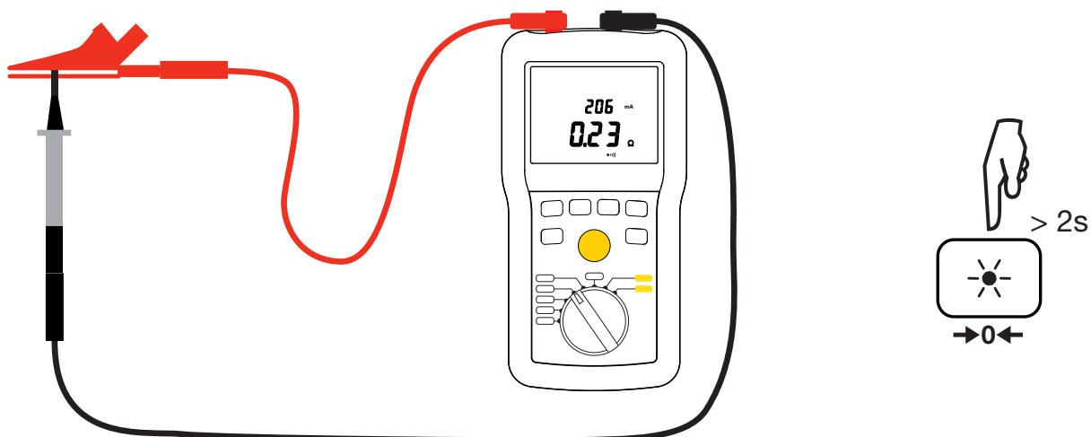
El display se pone a cero y aparece el símbolo →0←. Para todas las medidas de continuidad, se restará sistemáticamente la resistencia de los cables. Si la resistencia de los cables es > 10  $\Omega$ , la compensación no se realiza.
