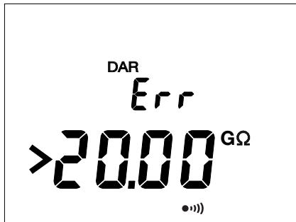
Para el C.A 6532, si esto ocurre durante una medida de DAR o PI, el instrumento interrumpe la medida y muestra la siguiente pantalla.
