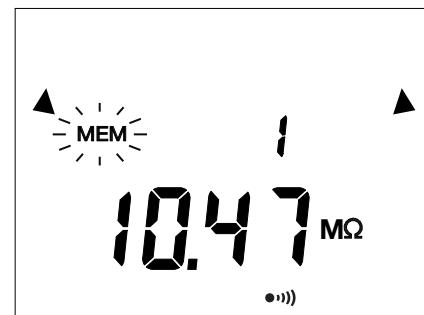
Se guarda con toda la siguiente información correspondiente y que no siempre se muestra al guardarlos: tensión, corriente, tiempo de la prueba T1 y T2 en el caso de PI y DAR, etc.
