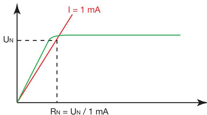
El rango de funcionamiento según la norma IEC 61557 es de 100 100kΩ a 2 GΩ. (véase § 3.4).
