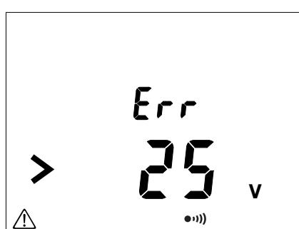
Antes de medir el aislamiento, el instrumento está en medida de tensión. Si una tensión superior a 25 V está presente en los bornes y usted intenta igualmente realizar una medida, el instrumento lo indica.
