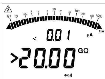
Durante la medida de aislamiento, si el valor a medir supera el rango de medida (el cual depende del instrumento y de la tensión de prueba), el instrumento lo indica.
