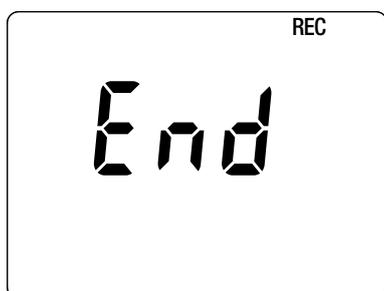
Si durante el inicio del instrumento aparece esta pantalla, es que se ha interrumpido repentinamente una sesión de registro debido a que se apagó el instrumento tras una interrupción de la alimentación.
