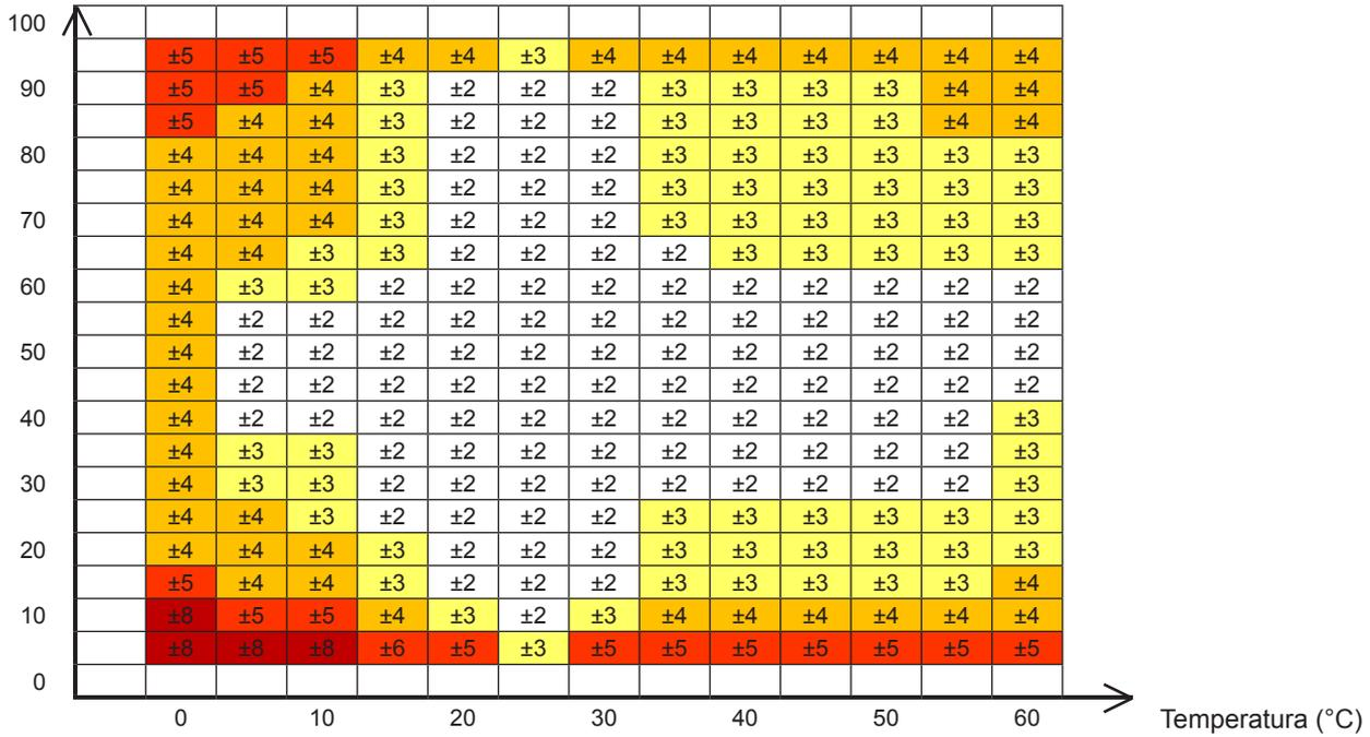
La humedad relativa depende principalmente de la temperatura. Para realizar una calibración del instrumento, los 2 sensores (el de referencia y el del instrumento) deben indicar la misma temperatura.
