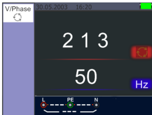
Pantalla de secuencia de fase cuando se conecta en sentido antihorario
