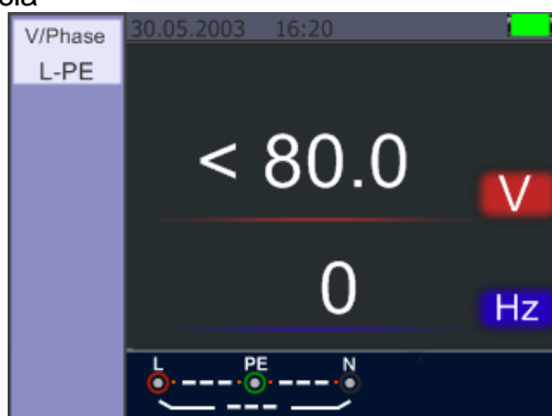
Pantalla de Standby para tensión y frecuencias
