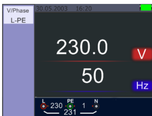
Pantalla en medición de tensión y frecuencia
