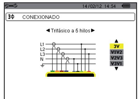
Figura 16: conexión trifásica de 5 hilos
