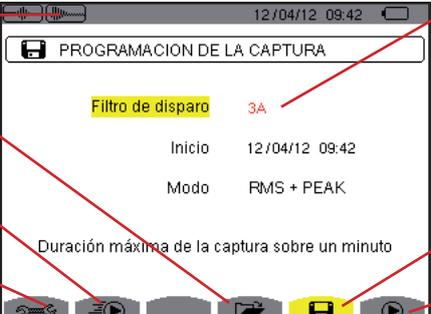
Figura 42: la pantalla *Programación de la captura* en modo corriente de inserción
