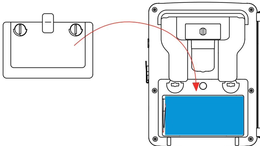
**Atención:** En el caso de que se haya desconectado la batería, aunque no haya sido cambiada, es imprescindible proceder a una recarga completa. Esto para permitir al instrumento conocer el estado de carga de la batería (información que se pierde al desconectarla).
