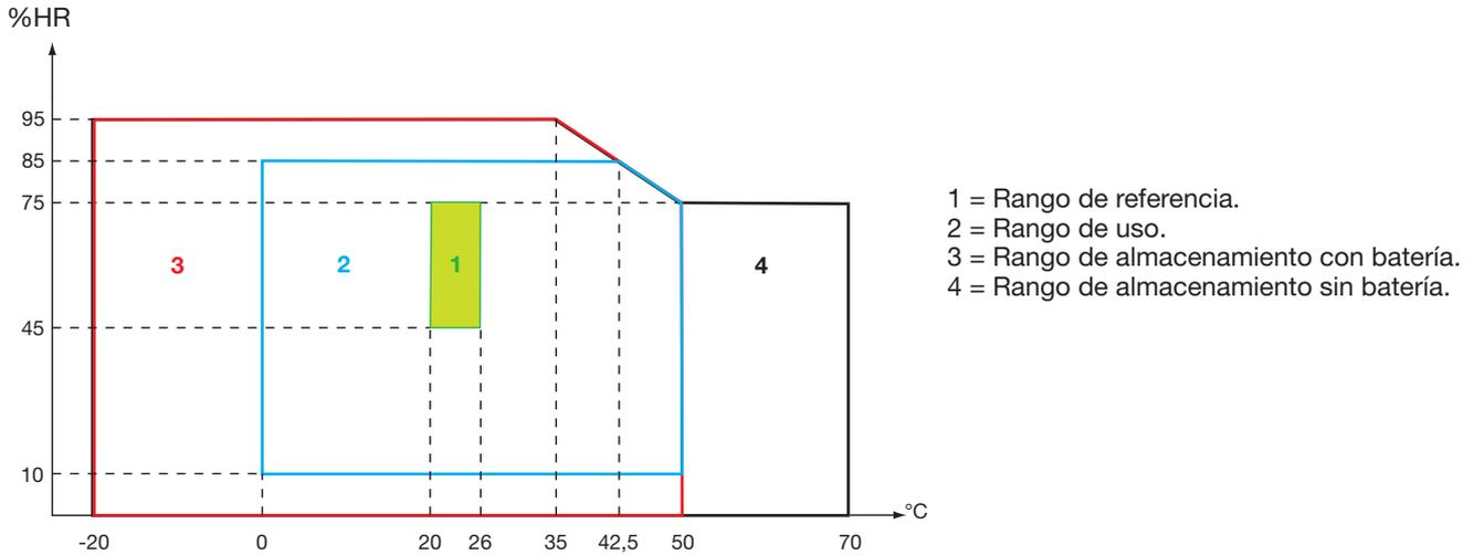
**Atención:** por encima de los 40 °C, el instrumento debe utilizarse sólo con la batería **O** sólo con un adaptador de red eléctrica. El uso del instrumento con simultáneamente la batería **Y** el adaptador de red eléctrica externo específico está **prohibido**.
