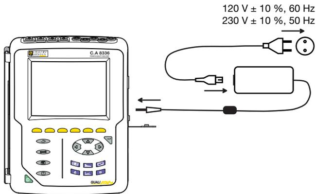
Quite la tapa de la toma y conecte el conector jack del adaptador de corriente específico al instrumento. Conecte el cable de red al adaptador de corriente y a la red.
