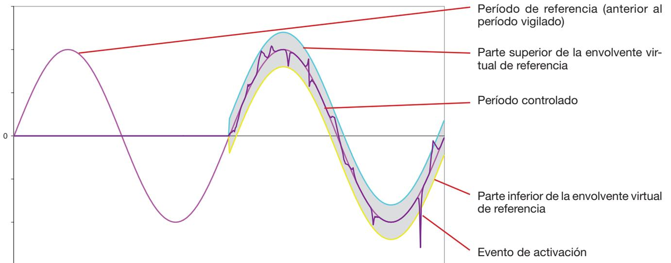
La mitad de la anchura de la envolvente virtual para la tensión y la corriente iguala el umbral programado en el modo Transitorio de la configuración (véase § 4.8).
