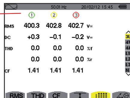
Figura 78: la pantalla de visualización simultánea en 3U
