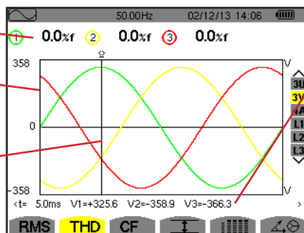
Figura 58: La pantalla de visualización THD en 3V
