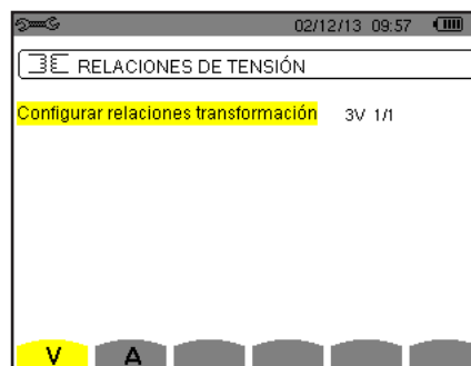
Figura 28: La pantalla Ratios de tensión en el menú Sensor y ratios en el caso de un montaje con neutro
