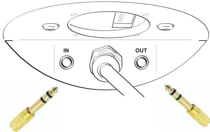
Die Steckverbindung zwischen den einzelnen Geräten geht über über spezielle Verbindungskabeln mit stereo Klinkenstecker, die im Lieferumfang enthalten sind..
