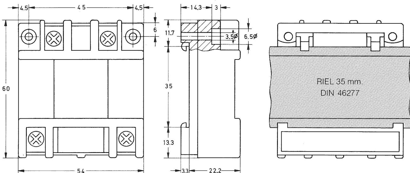
El relé **ZTE**, serie compacta, se suministra con doble sistema de sujeción, tornillo o riel 35 mm DIN 46277.
