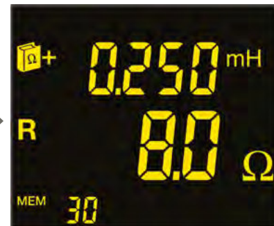
Paso 3: valor de la parte resistiva e inductiva de la impedancia medida
