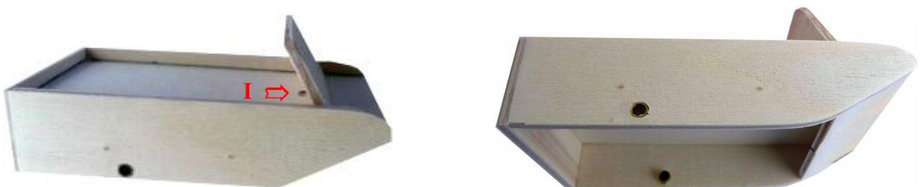
F) Se tiene de lijar el canto superior de la pieza inferior delantera (50 x 25 x 3 mm) unos 60°, para que ajuste bien con el tablero superior.
