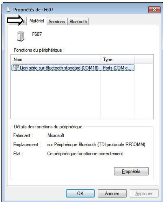
2.3 Conexión del instrumento en curso con el software PAT, mediante Bluetooth. Sólo se debe seleccionar "Puerto COM" para comunicarse, seleccione el puerto COM correcto (aquí COM18).
