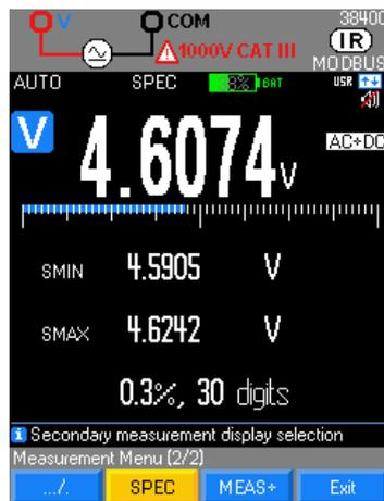
A partir de las especificaciones técnicas internas al multímetro, el modo **SPEC** indica directamente la tolerancia de la medida en curso, sin que se tenga que buscar y calcular.
