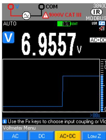
En esta posición, el usuario puede medir el verdadero valor eficaz de una tensión alterna con su componente continua (sin acoplamiento capacitivo): medida llamada **TRMS**.
