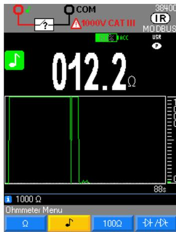
Medida del valor de una resistencia de hasta 1.000 Ω, con indicación acústica continua a 4 kHz.
