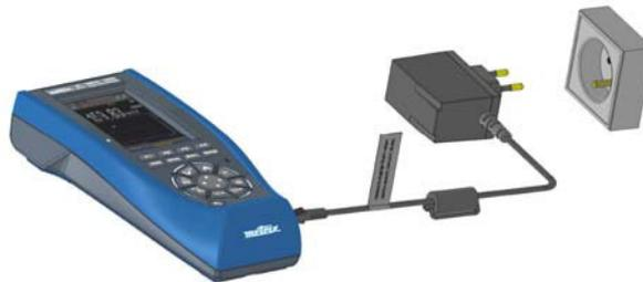
Usted puede cargar los acumuladores sin quitarlos. Utilice el cargador externo suministrado con el multímetro. Durante la fase de carga, el multímetro sigue operativo.
