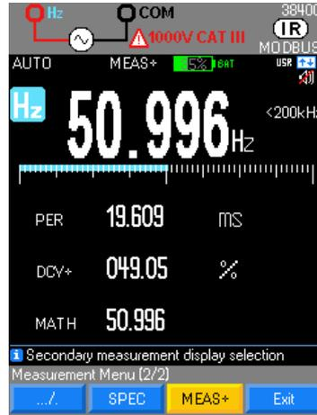
El modo de ciclo de trabajo DCY está optimizado para medir los intervalos activos o inactivos de las señales de conmutación o señales lógicas. Los sistemas de inyección de combustible electrónicos, y especialmente las alimentaciones conmutadas, son controlados por impulsos de anchura variante que se pueden comprobar con una medida de ciclo de trabajo.
