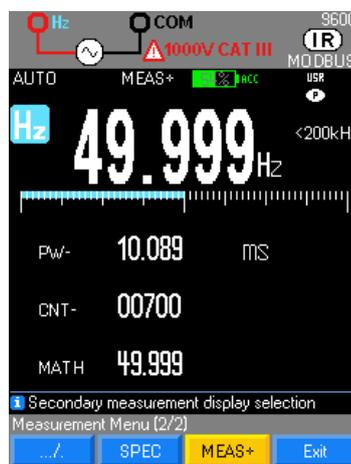
Según las condiciones de activación del frecuencímetro, se mide la anchura de impulso en ms.
