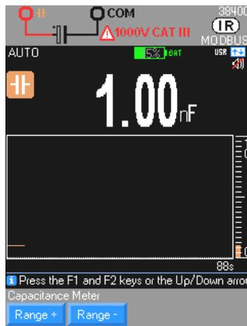
Medida de la capacidad de un condensador con una resolución de 1.000 pts
