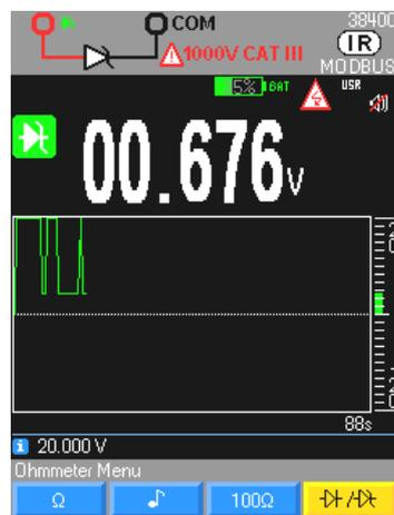
Diodo Zener o LED, la selección de este diodo es una función idéntica al diodo más arriba pero con una tensión máxima de 26 V y una corriente máxima de 10 mA.
