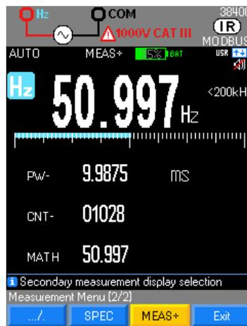
Según las condiciones de activación del frecuencímetro, se calculan los impulsos positivos o negativos.
