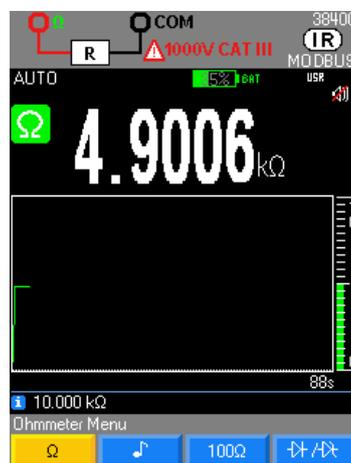
En el rango 50 M $\Omega$ , para evitar la influencia de la red y garantizar las especificaciones indicadas, se recomienda desconectar el multímetro del Wall Plug.
