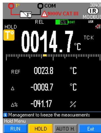
Medida de la temperatura mediante un termopar entre los 2 bornes V y COM en °Celsius
