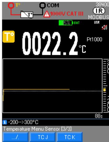
Medida de la temperatura con un sensor: Pt100/Pt1000 o ./...
