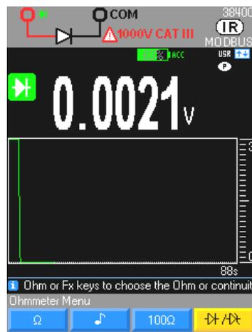
Lectura del valor de tensión de umbral, aparece O.L si el circuito está abierto o si el umbral del diodo es >4 V.
