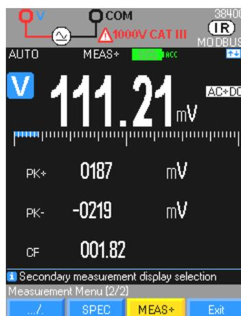
Se puede acceder a las medidas de peak rápidas en las medidas secundarias **MEAS, MEAS+, PK+** y **PK-** para las siguientes funciones de medida: V y A (AC, AC+DC); tiempo de integración a 250  $\mu$ s.
