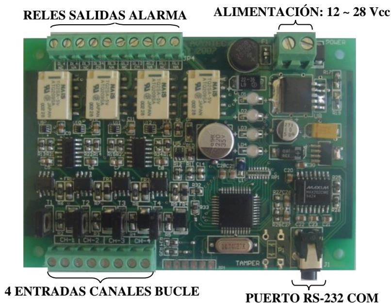
Figura 1. Detalle de conexiones y puerto de comunicaciones
