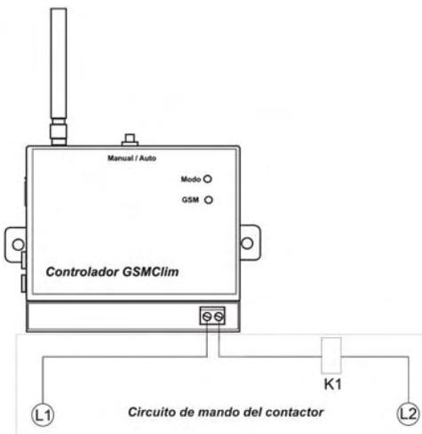
**Importante:** Si se va a utilizar el GSMClim para activar sistemas de calefacción en los que sea necesario que a través del interruptor de activación circulen corrientes superiores a 3A (220VAC), se deberá colocar un "contactor" adecuado a este consumo, en esta caso se recomienda que la instalación la realice personal cualificado.
