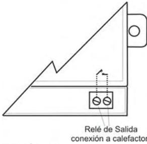
El GSMClim dispone de un interruptor interno para activar la calefacción ( máx. 3A - 220 VAC), que se conectará a la toma de termostato externo de su calefactor (**gas ó gasoil**)
